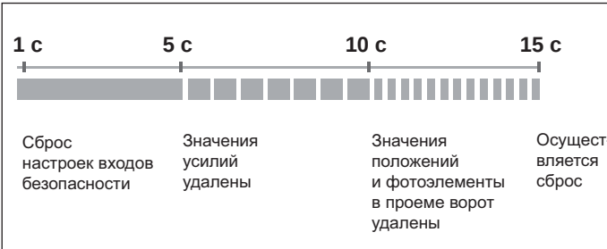
Рис. Обзор последовательности во времени работы светодиодов статуса (Status) на каретке при нажатии зеленой кнопки Reset
